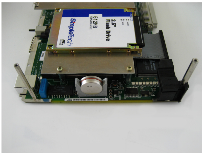
Bild 1-9 Batterie auf der CPU-Baugruppe
